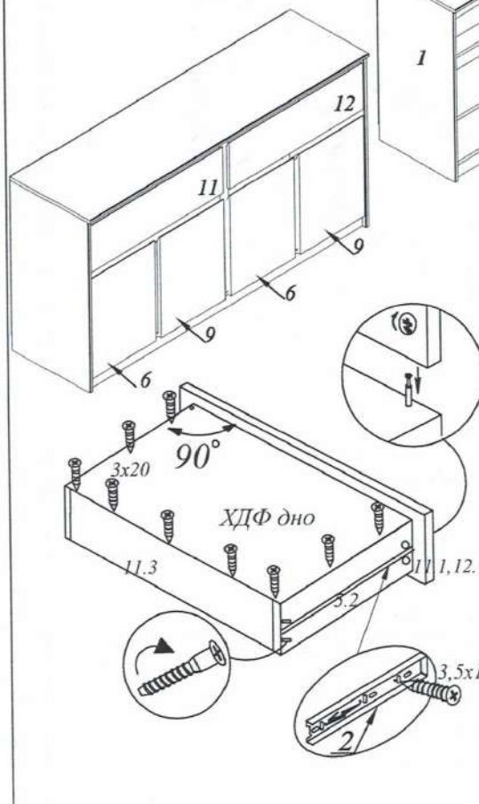
Нажать деблокировочный рычаг для снятия части 2, закрепить ее на блок ящика по наколкам для регулировочного отверстия, затем зафиксировать направляющие шурупами 3,5x16 в круглые отверстия
